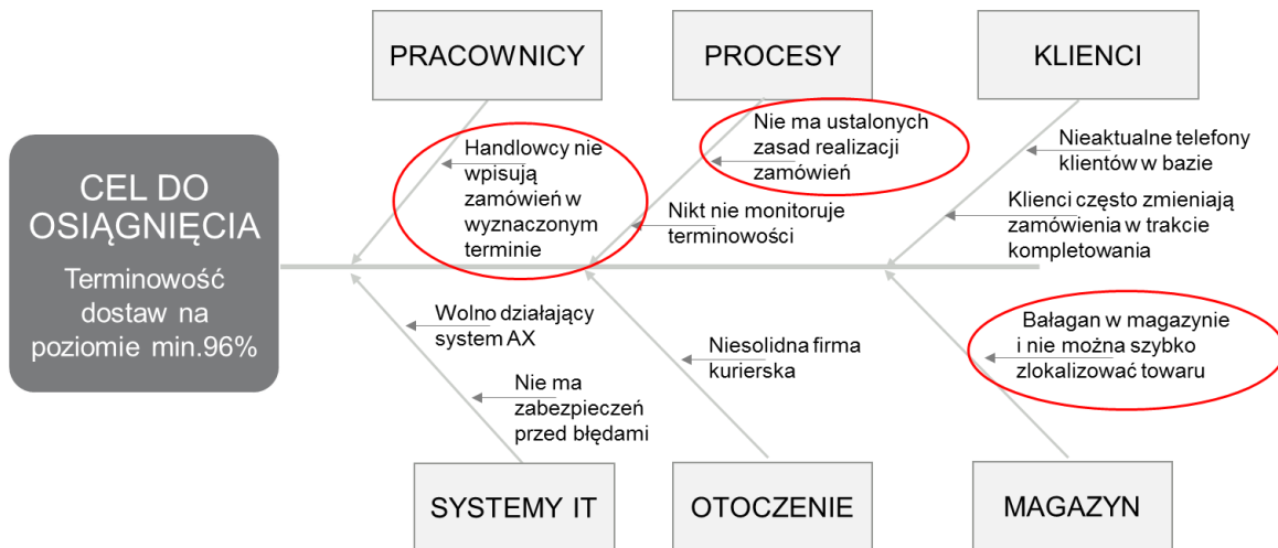
Rysunek 11. Przykład zastosowania wykresu Ishikawy w identyfikowaniu przyczyn wpływających na realizację celu
