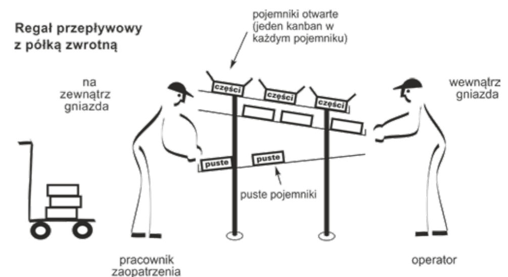
Fragment systemu ssącego do sterowania przepływem materiałów nabywanych 9 .
